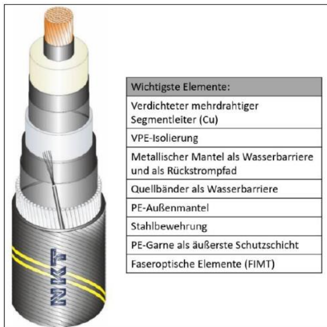
Schematische Darstellung des Seekabels (Quelle: NKT)
